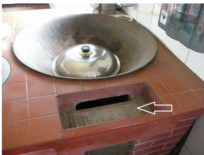
圖4-1-1 孔明灶（稻殼放入箭頭處，自動被吸風口吸入。）
